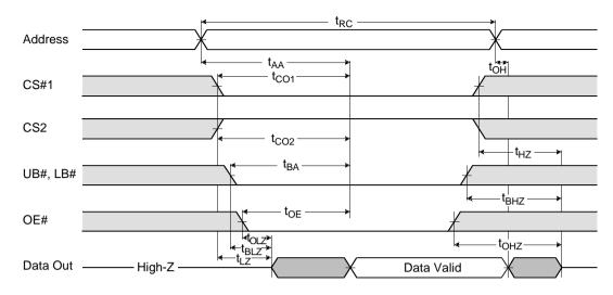
Figure 29. SRAM Read Cycle
