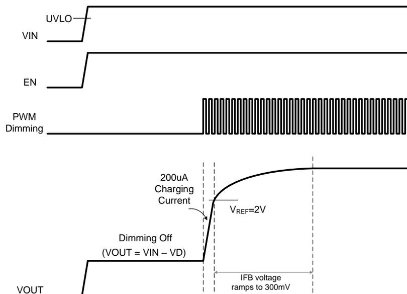
Figure 17. Soft-Start Waveforms
