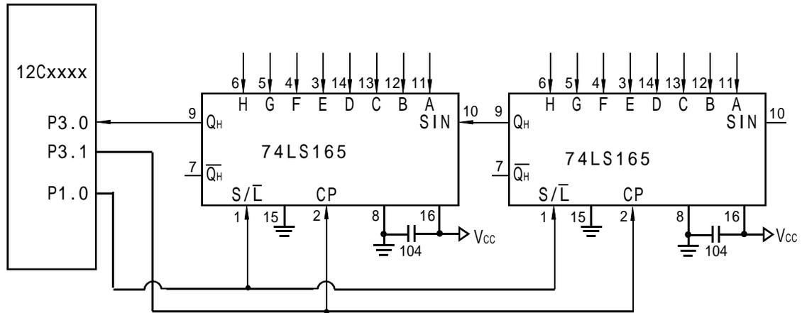
74LS165 是 8 位并行置入移位寄存器。当移位 / 置入端 ( $S/\bar{L}$ ) 由高到低跳变时，并行输入端的数据置入寄存器；当  $S/\bar{L}=1$ ，且时钟禁止端 (第 15 脚) 为低电平时，允许时钟输入，这时在时钟脉冲的作用下，数据将由  $Q_A$  到  $Q_H$  方向移位。
