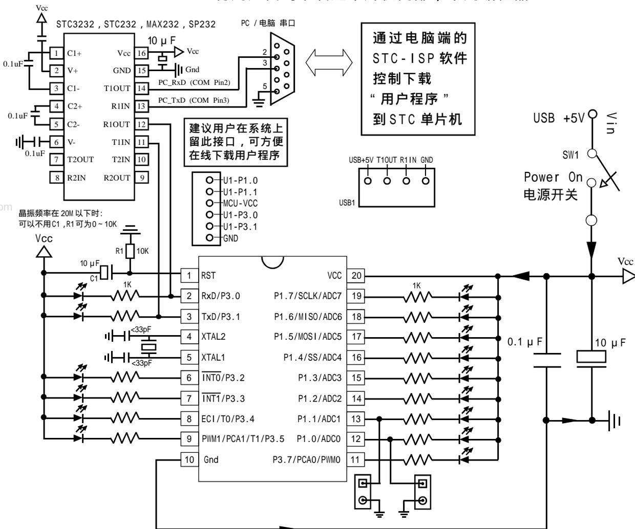
STC12C5410AD 系列单片机具有在系统可编程 (ISP) 特性, ISP 的好处是: 省去购买通用编程器, 单片机在用户系统上即可下载 / 烧录用户程序, 而无须将单片机从已生产好的产品上拆下, 再用通用编程器将程序代码烧录进单片机内部。有些程序尚未定型的产品可以一边生产, 一边完善, 加快了产品进入市场的速度, 减小了新产品由于软件缺陷带来的风险。由于可以在用户的目标系统上将程序直接下载进单片机看运行结果对错, 故无须仿真器。
