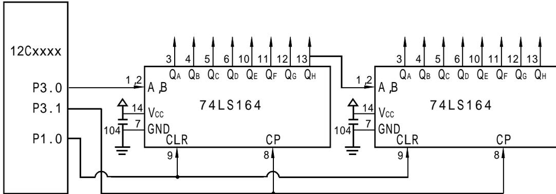
当单片机串行口工作在方式 0 的发送状态时，串行数据由 P3.0 (RXD) 送出，移位时钟由 P3.1 (TXD) 送出。在移位时钟的作用下，串行口发送缓冲器的数据一位一位地移入 74LS164 中。需要指出的是，由于 74LS164 无并行输出控制端，因而在串行输入过程中，其输出端的状态会不断变化，故在某些应用场合，在 74LS164 的输出端应加接输出三态门控制，以便保证串行输入结束后再输出数据。
