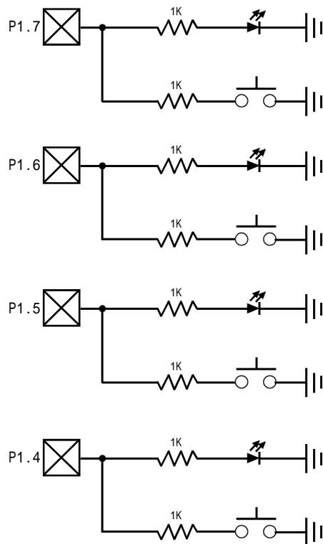
利用 STC12C5410 系列单片机的 I/O 口可设置成弱上拉, 强上拉(推挽)输出, 仅为输入(高阻), 开漏四种模式的特性, 可以利用 STC12C5410 系列单片机的 I/O 口同时作为发光二极管驱动及按键检测用, 可以大幅节省 I/O 口。
