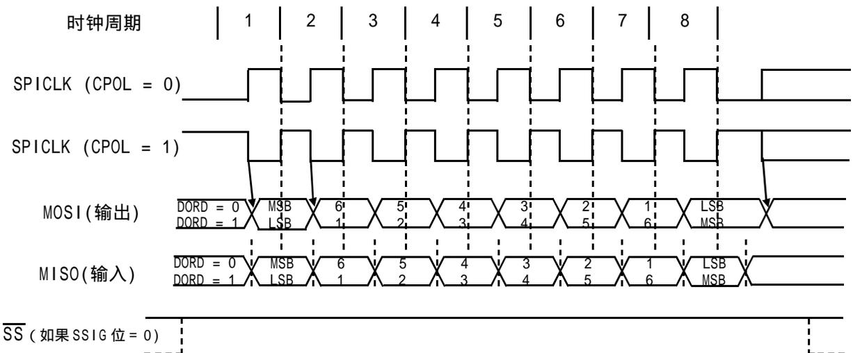
SPI 图7 SPI 主机传输格式 (CPHA=1)
