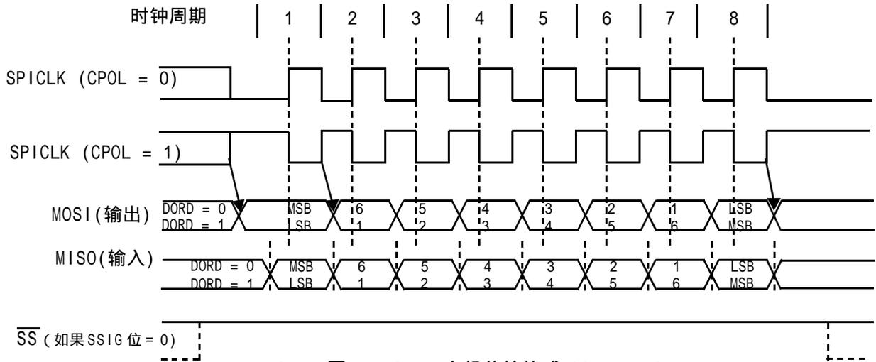
SPI 图6 SPI 主机传输格式 (CPHA=0)
