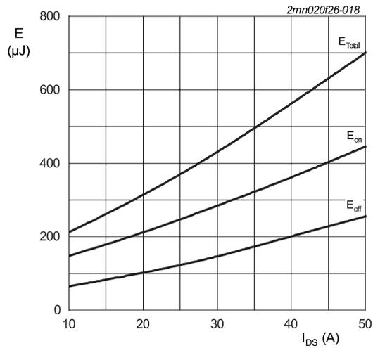
$T_j = 25\text{ }^\circ\text{C}$ ;  $V_{DD} = 600\text{ V}$ ;  $R_{G(ext)} = 2.4\ \Omega$ ;
