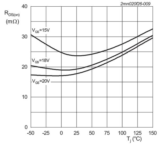
$I_{DS} = 50\text{ A}$ ;  $t_p < 200\ \mu\text{s}$
