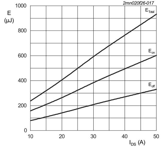
$T_j = 25\text{ }^\circ\text{C}$ ;  $V_{DD} = 800\text{ V}$ ;  $R_{G(ext)} = 2.4\ \Omega$ ;
