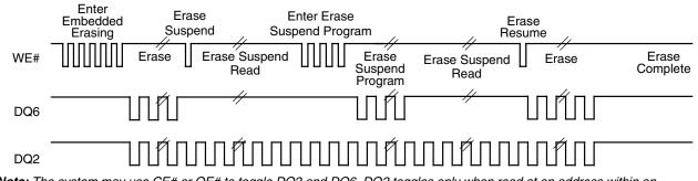
**Note:** The system may use CE# or OE# to toggle DQ2 and DQ6. DQ2 toggles only when read at an address within an erase-suspended sector.
