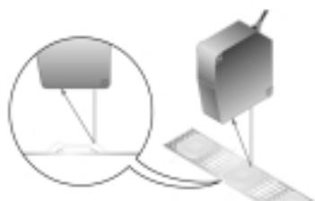
Misurazione dello spessore dei dischi di freni
