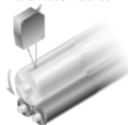
Rilevamento della presenza di un rivestimento in resina
