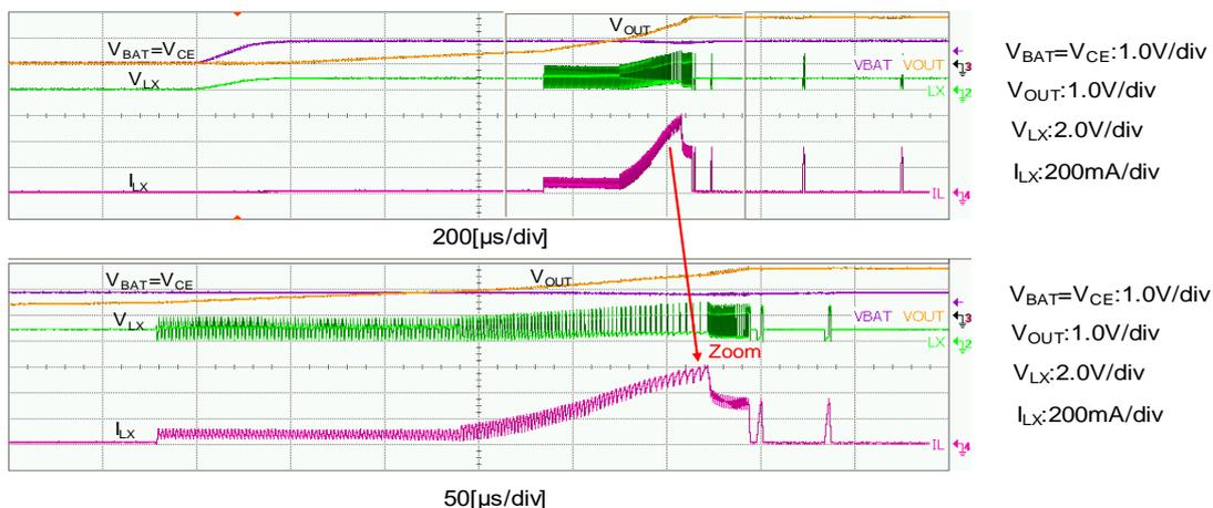
$V_{BAT}=V_{CE}=0 \rightarrow 1.7V$ ,  $V_{OUT}=1.8V$ ,  $I_{OUT}=1mA$ ,  $L=4.7\mu H$ ,  $C_L=10\mu F$ ,  $T_a=25^\circ C$
