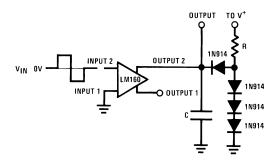
$V_{IN}$ =±50 mV FANOUT=1 FANOUT=4  $V^{+}$ =+5V R=2.4k R=630 $\Omega$  V=-5V C=15 pF C=30 pF
